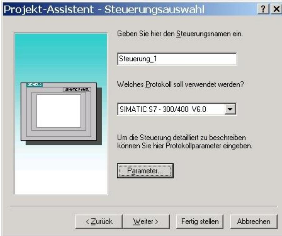
4. Drücken Sie „Weiter“ und Sie gelangen zu einem neuem Dialog indem Sie den Steuerungsnamen sowie die Steuerung angeben können die Sie verwenden.
