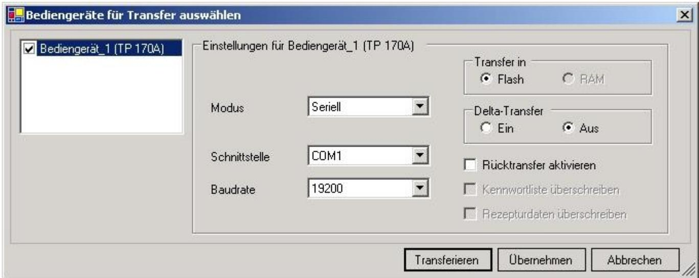
9. Mit „Transferieren“ wird die Kommunikation mit dem Bedienterminal gestartet und Ihr Projekt wird übertragen. Die Kommunikation mit dem Bedienterminal ist somit erfolgreich aufgebaut.
