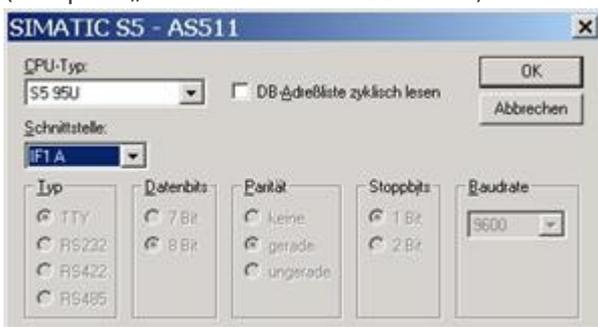
5. Über „Parameter...“ rufen Sie einen Einstellungsdialog für die ausgewählte SPS auf. Wählen Sie den verwendeten „CPU-Typ“ und die „Schnittstelle“ an der das Terminal verbunden ist (im Beispiel „IF1 A“).
