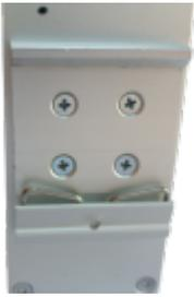
Auf der Rückseite befinden sich vier Schraubenlöcher. Montieren Sie die mitgelieferte Hutschienehalterung, dass die Feder nach unten zeigt. **Montage:**
